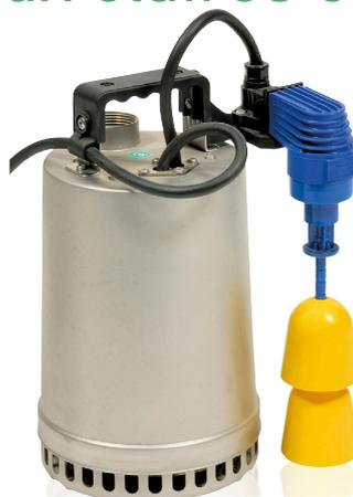
Les électropompes DR STEEL sont des pompes de type submersible pour usage domestique, adaptée au relevage des eaux claires ou d'infiltration pouvant contenir des corps solides jusqu'à 10 mm de diamètre. Leur conception spéciale avec flotteur de commande vertical permettent à ces pompes d'être installées dans des regards avec dimensions étroites.
