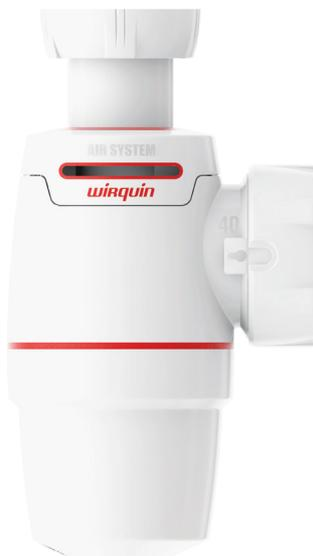
Garanti zéro fuite grâce à ses joints bi-injectés, Wirquin NEO AIR est fiable, rapide et facile à installer. Sa fonction AIR SYSTEM innovante et brevetée permet la ventilation des canalisations, empêche l'aspiration de garde d'eau et supprime le bruit et les mauvaises odeurs provenant des canalisations. Wirquin NEO AIR : la garantie d'une installation fiable et efficace et du confort de l'utilisateur final.
