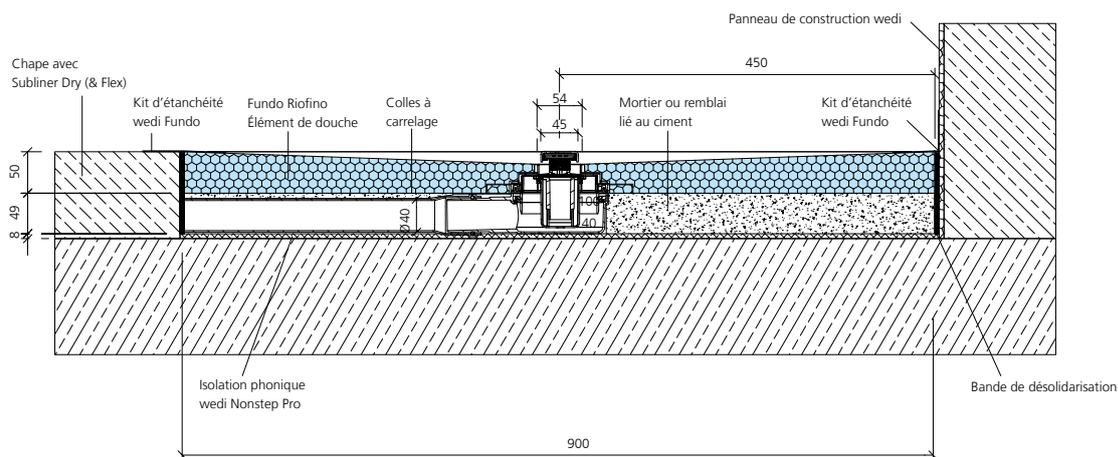
Écoulement linéaire wedi Fundo vertical, DN 50, pose sur chape
