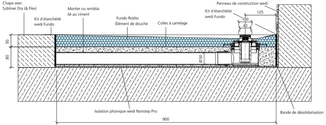
Écoulement linéaire wedi Fundo Mini Max, DN 40, pose sur chape
