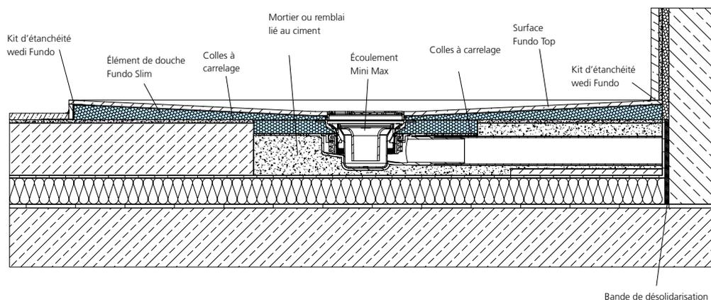
Écoulement en un point wedi Fundo horizontal, DN 50, intégré en chape
