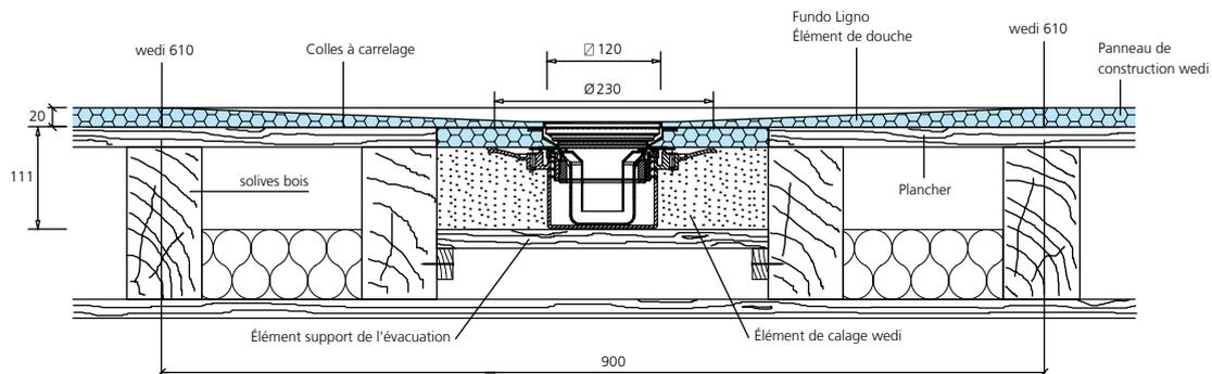
Écoulement en un point wedi Fundo Mini Max, DN 40, pose sur plancher bois
