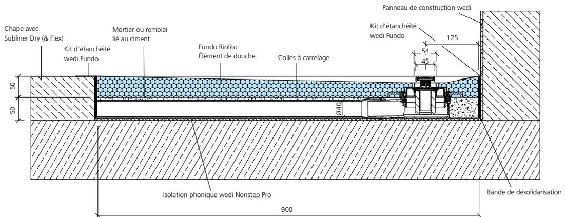
Écoulement linéaire wedi Fundo vertical, DN 50, pose sur chape
