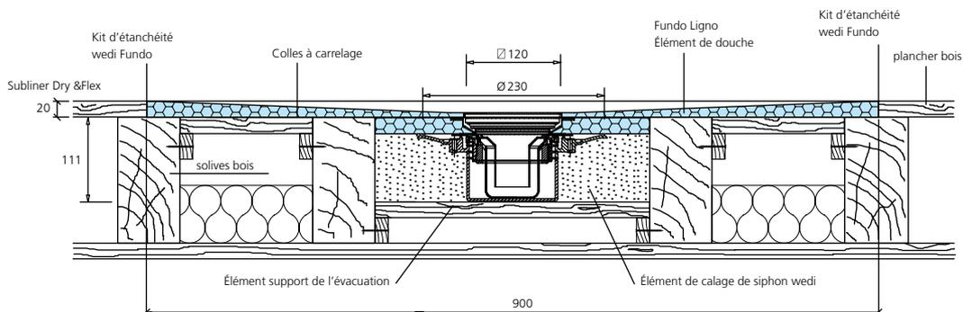
Écoulement en un point wedi Fundo Mini Max, DN 40, intégré au plancher bois
