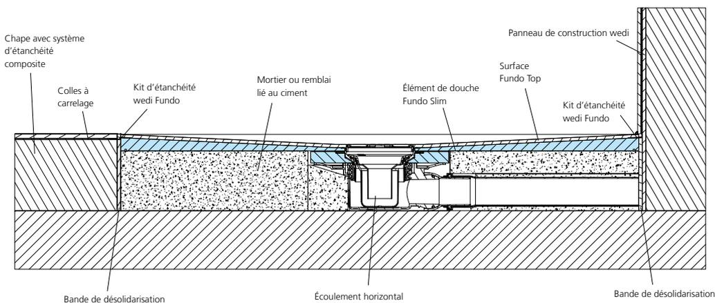
Écoulement en un point wedi Fundo horizontal, DN 50, intégré au plancher bois
