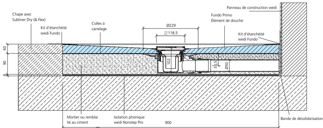
Écoulement en un point wedi Fundo Mini Max, DN 40, pose sur chape
