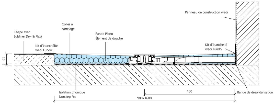
Fundo Plano, Système complet A, sortie sur le grand côté
