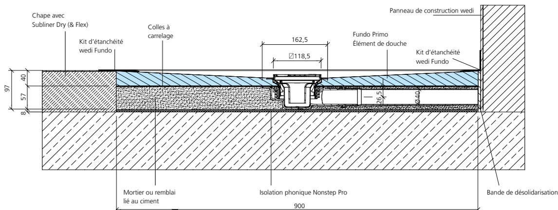
Écoulement en un point wedi Fundo vertical, DN 50, pose sur chape
