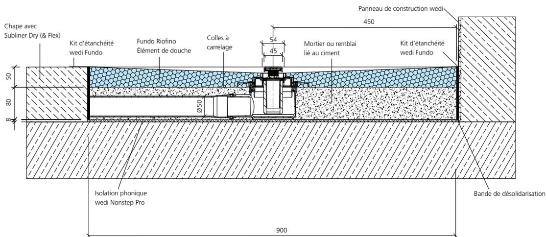
Écoulement linéaire wedi Fundo Mini Max, DN 40, pose sur chape
