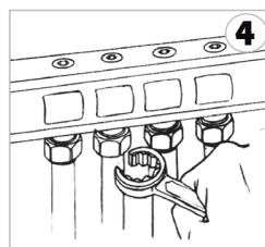
4 Serrer l'écrou à refus à l'aide de la clef R131. Après les essais d'usage et les essais en température maximale admissible, on vérifiera le serrage des écrous.
