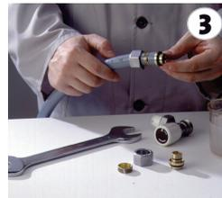
3 Enfoncer le tube bien à fond dans la tête du raccord et positionner le joint O-Ring à fond de gorge.
