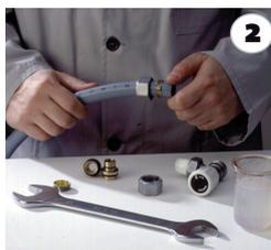
2 Enfiler l'écrou et la bague sur le tube de façon à ce que le tube dépasse d'environ 2 mm de la bague.
