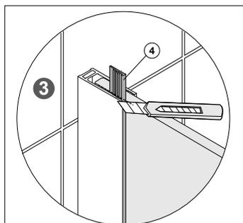
Le joint doit être coupé après 24H du fait d'une possible rétraction après installation
