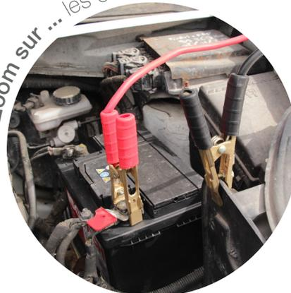
Câble de démarrage 700 A. 4,5 m - 35 mm<sup>2</sup>. 100% cuivre.
