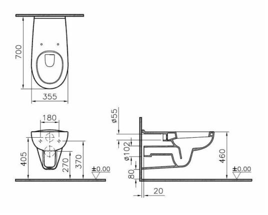
**Description:** Conforma WC suspendu 700 mm PMR, accessibilité aux personnes à mobilité réduite, adapté pour chaise roulante, capacité de chasse d'eau 3/6 l, avec tubulure rallongée. Montage surélevé requis pour l'obtention d'une hauteur de siège de 480 mm, selon DIN 1385-6, DIN-EN 38, DIN 18040, DIN-EN 997. Compatible avec abattant #84-003xxxx, #115-003-006, #115-003-506.
