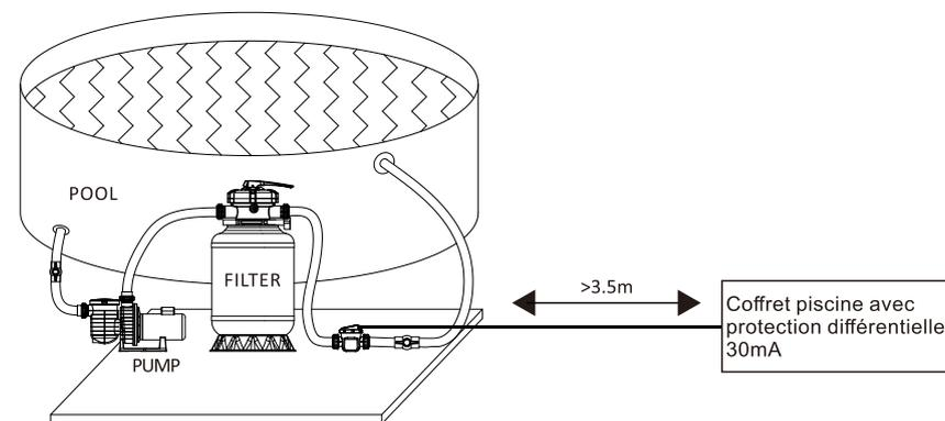
Le bloc d'alimentation de l'électrolyseur au sel doit être installé sur une source d'alimentation indépendante et équipé d'une protection différentielle 30mA, à l'abri de la pluie et à plus de 3,5 m du bassin. En cas de déclenchement de la protection différentielle, vérifier l'intégrité du système avant de réarmer. En cas de doute faites appel à un professionnel.
