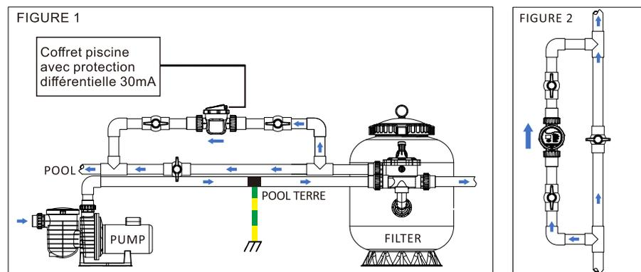
**Pour insérer l'électrolyseur sur un tuyau existant (ou l'encombrant sur le tuyau) il faut couper sur 230mm**
