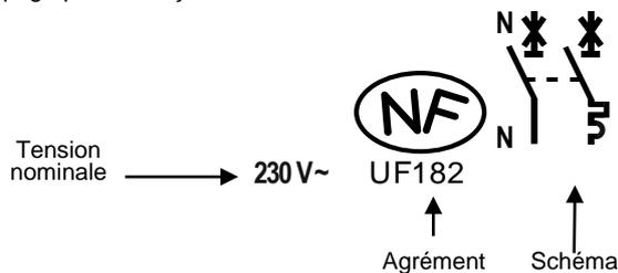
. Les bornes amont et aval du pôle neutre sont repérées par un « N » moulé à proximité des têtes de vis.
