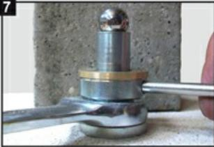
Pour maintenir la côte, Bloquer l'ensemble (bague et écrou plat) avec la clé de 22 et la tige lisse.
