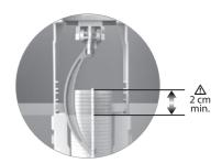
Régler le niveau d'eau à l'aide de la vis de réglage. Visser pour augmenter, dévisser pour diminuer le niveau.
