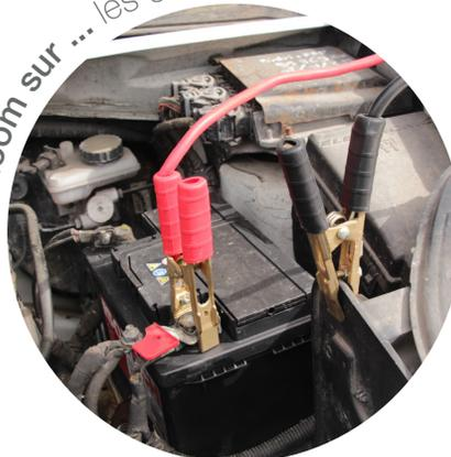
Câble de démarrage 500 A. 3 m - 25 mm<sup>2</sup>. 100% cuivre.
