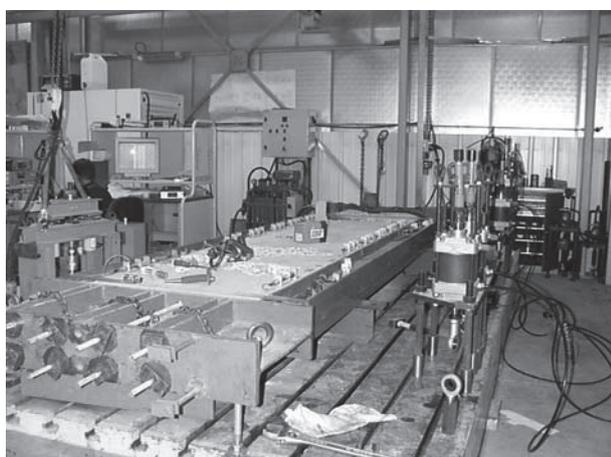
Equipement pour essais dans béton fissuré
