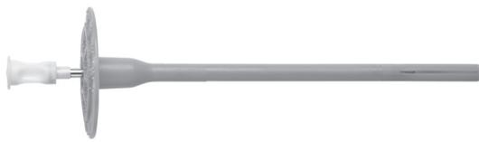
Cheville à frapper avec clou d'expansion en acier pour fixation de polystyrène expansé (EPS) et panneaux de laine minérale pour isolation thermique extérieure par enduit (ETICS)
