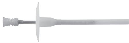
Cheville à visser avec clou d'expansion en acier pour fixation d'isolants rigides (montage à fleur ou à coeur) pour isolation thermique extérieure par enduit (ETICS)
