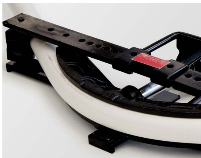
Cintrage diamètre 90 mm
