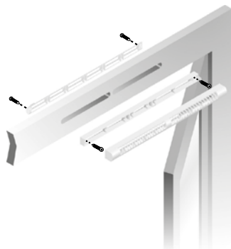
Mise en œuvre entrée d'air EMMA
